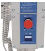
緊急停止ボタン
